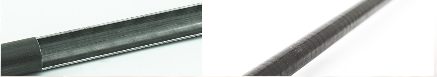
Abbildung 1: Sichtbare Rattermarken an der Innen- und Außenseite des Rohres.
