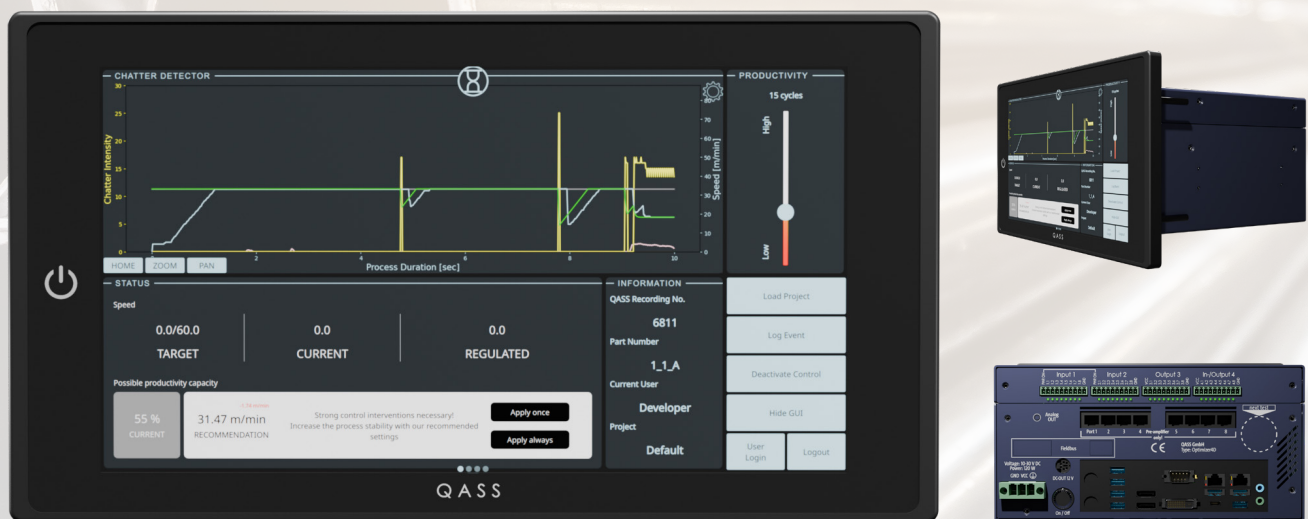
Abbildung 2: Messsystem Optimizer4D mit grafischer Oberfläche für Rohrzugprozesse.
