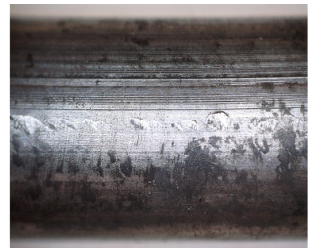
Draht mit deutlich erkennbaren Ziehriefen
